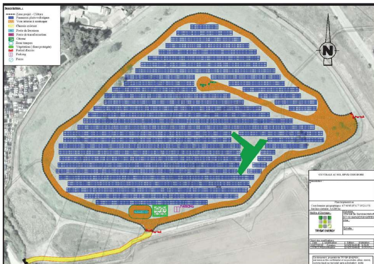
Illustration 39 : Variante d'implantation de la centrale pour préserver la flore présente sur site, Source : Tryba Energy
