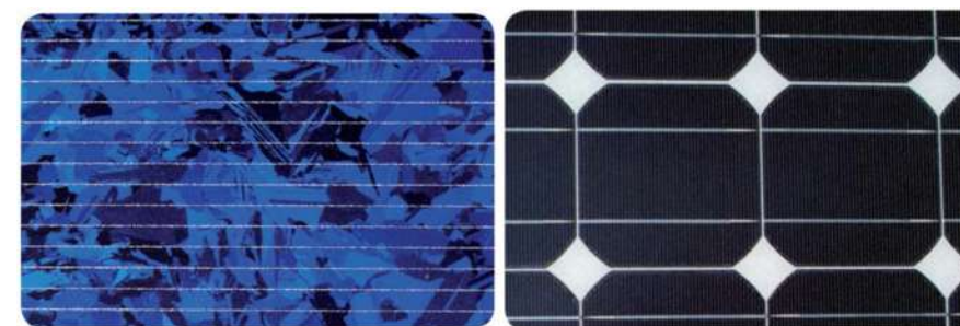
Gauche : cellules en silicium cristallin / Droite : cellules en mono cristallin
