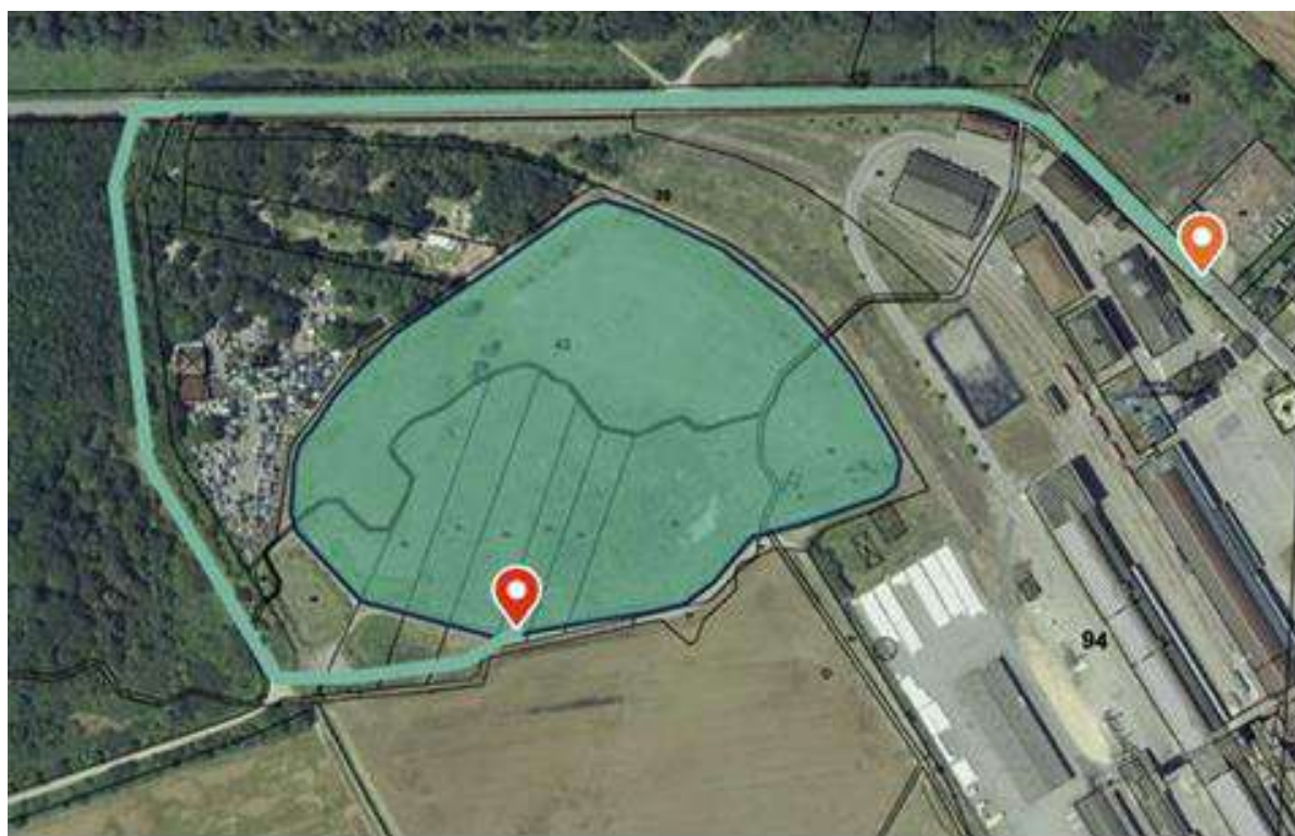
Illustration 9 : Raccordement de la centrale au réseau public à 1,08 km par la route (option 2)
