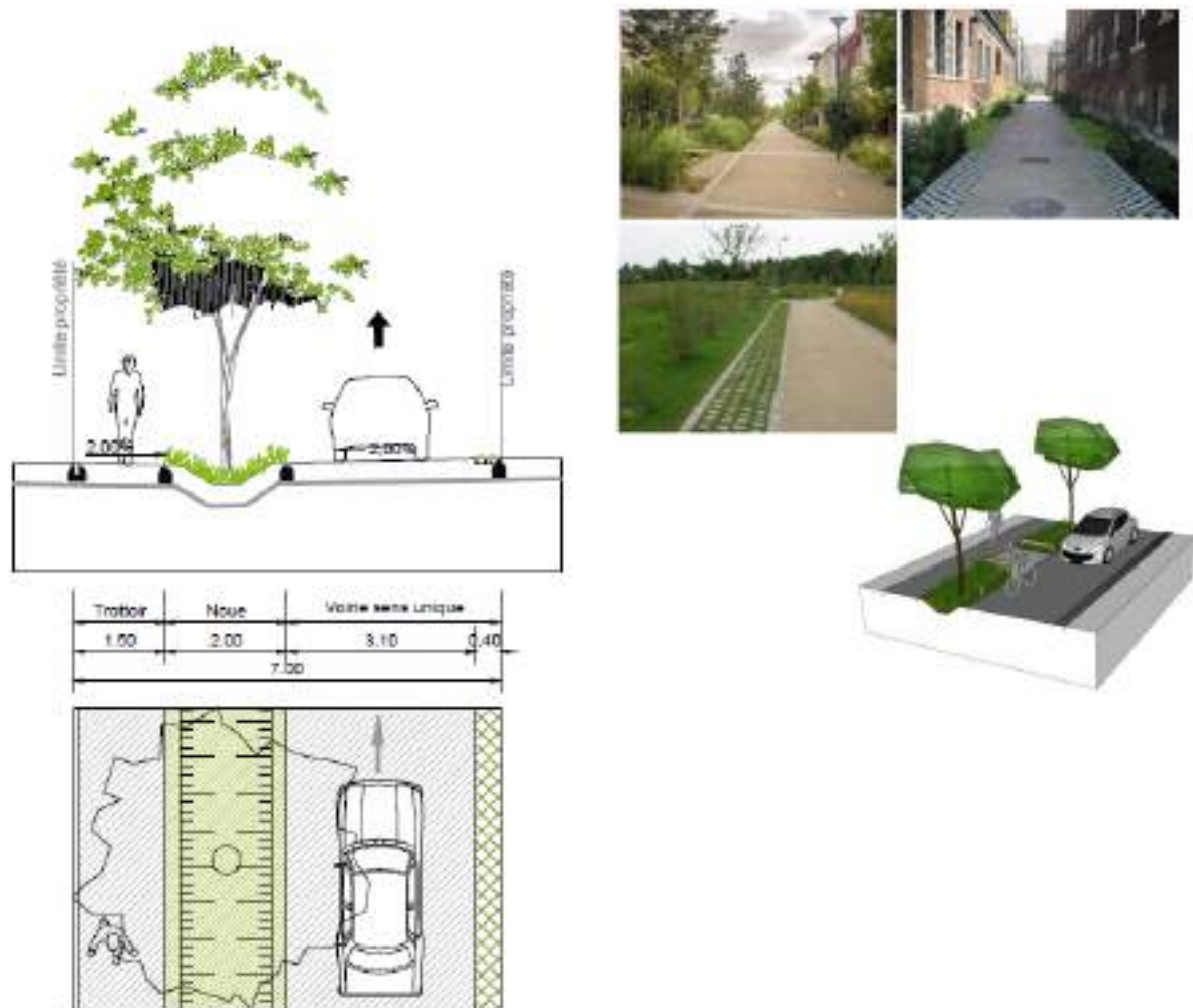
Fig.11 Profil type et illustration des voies tertiaires
