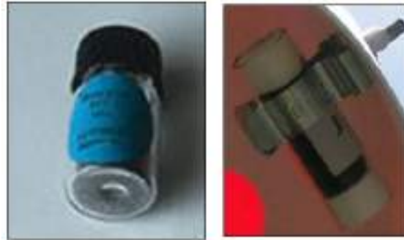
Fig.5 Tube pour mesurer les BTEX
