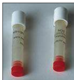
Fig.4 Tubes passifs pour mesurer les NO2
