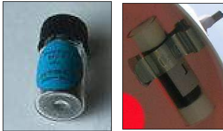
Figure 10 : Tube pour mesurer les BTEX
