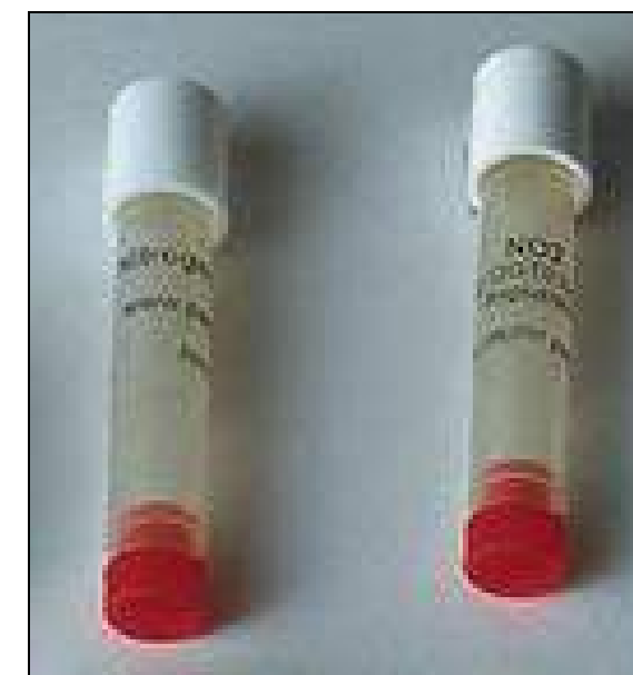
Figure 8 : Tubes passifs pour mesurer les NO 2
