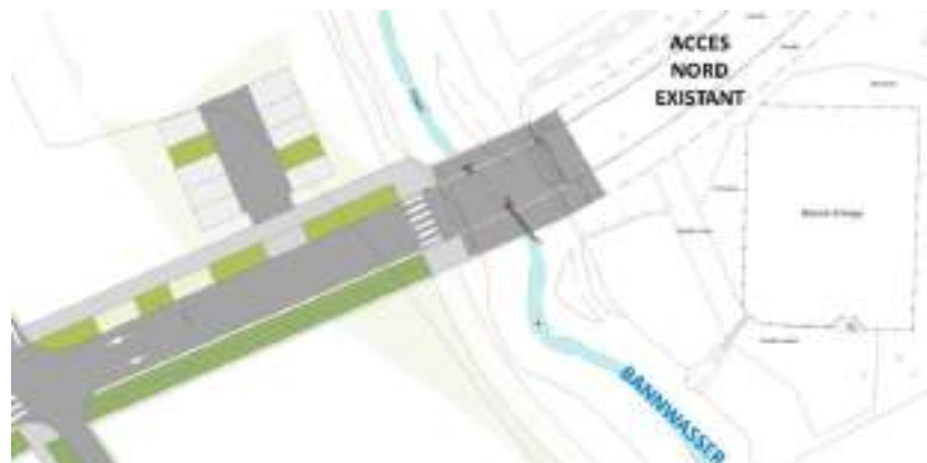
Fig.13 Vue en plan de l'ouvrage de franchissement
