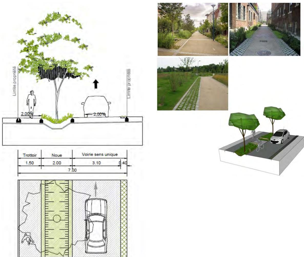
**Fig.11** Profil type et illustration des voies tertiaires
