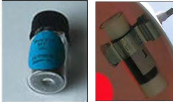
*Fig.5 Tube pour mesurer les BTEX*
