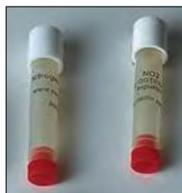
Fig.4 Tubes passifs pour mesurer les NO2
