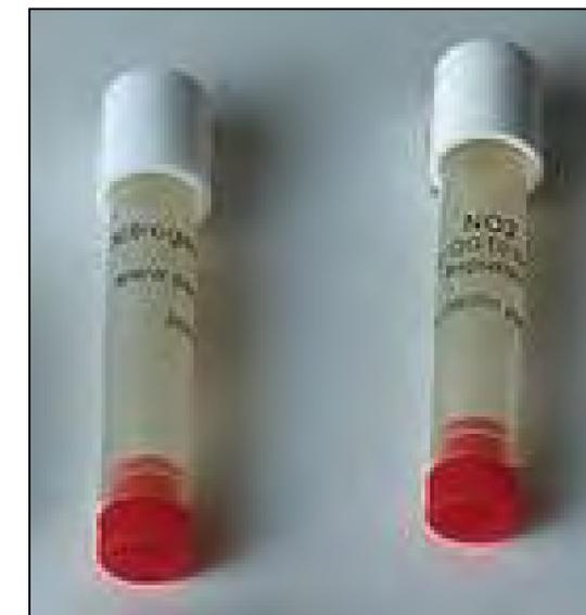
Figure 8 : Tubes passifs pour mesurer les NO<sub>2</sub>
