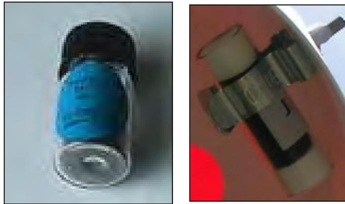
Figure 10 : Tube pour mesurer les BTEX
