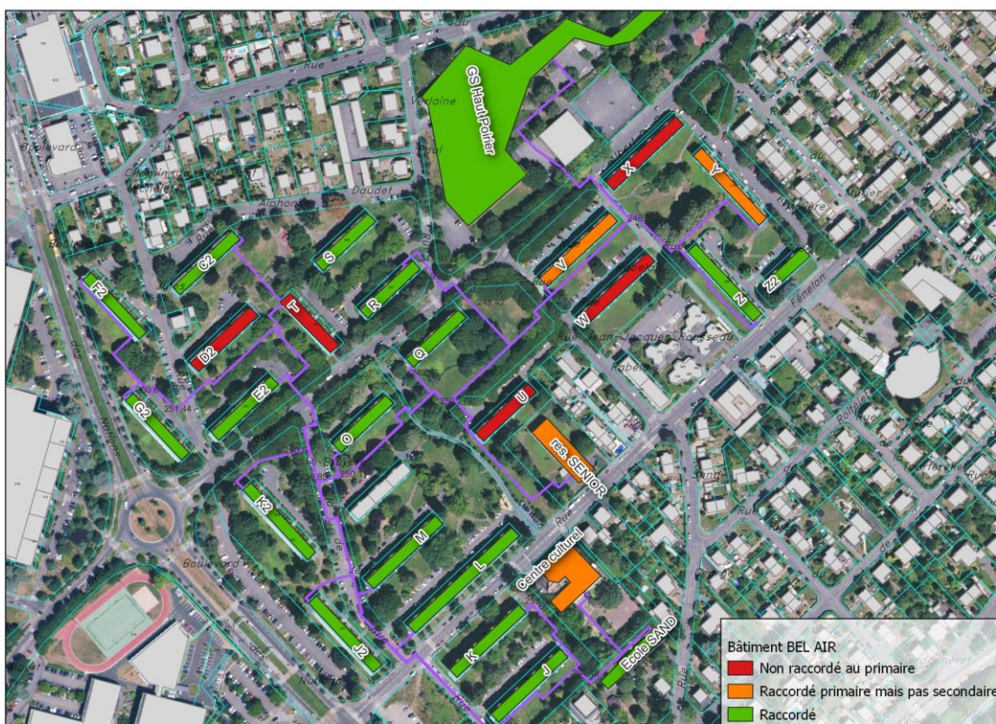
Réseau de chaleur du quartier Bel-Air
