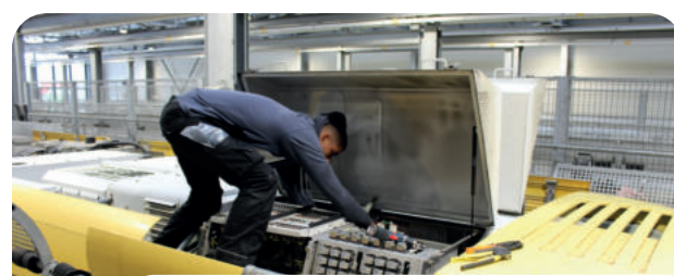
Équipement à bord des tramways de cellules de comptage et de boîtiers Flowly dans les bus
